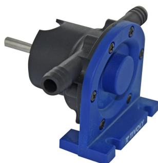
Trasvase de líquidos excepto aceite, gasolina, alcohol, ácido. Caudal 1300 litros/hora. Velocidad de rotación: 2800rpm. Nunca use en seco y asegure la bomba de forma segura a una tabla o soporte fijo.
