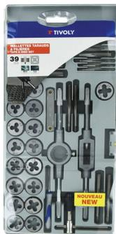
17 tarauds 1 passe en acier au carbone + 17 filières en acier au carbone M3 x50 MF3 x60 M4 x70 MF4 x75 M5 x80 MF5 x90 MF6 x75 M6 x100 MF7 x75 M7 x100 MF8 x100 M8 x125 MF10 x125 M10 x150 MF12 x150 M12 x175 NPT1/8" + 1 jauge de filetage + 1 tournevis + 2 porte-tarauds + 1 porte-filière -Coffret MTF39
